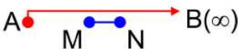
Рисунок 13 – трёхэлектродная установка (Pole-Dipole)
